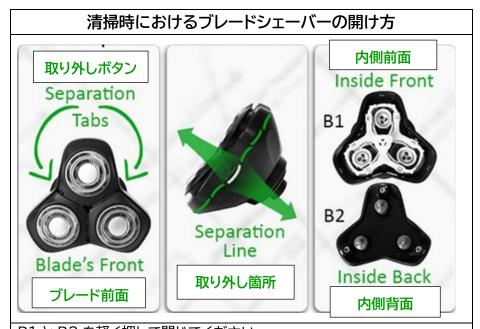
B1 と B2 を軽く押して閉じてください。 最適な性能を得るために、シェービング中は頻繁にすすぎ洗い(リンス)を してください。
